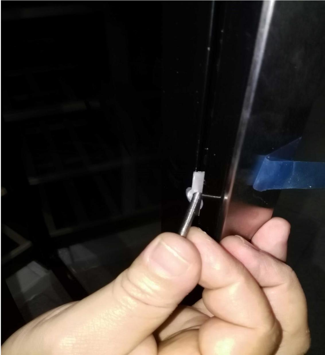
**3º Una vez dentro, con un destornillador, apretar el tirador y volver a colocar el burlete dentro de la ranura**
