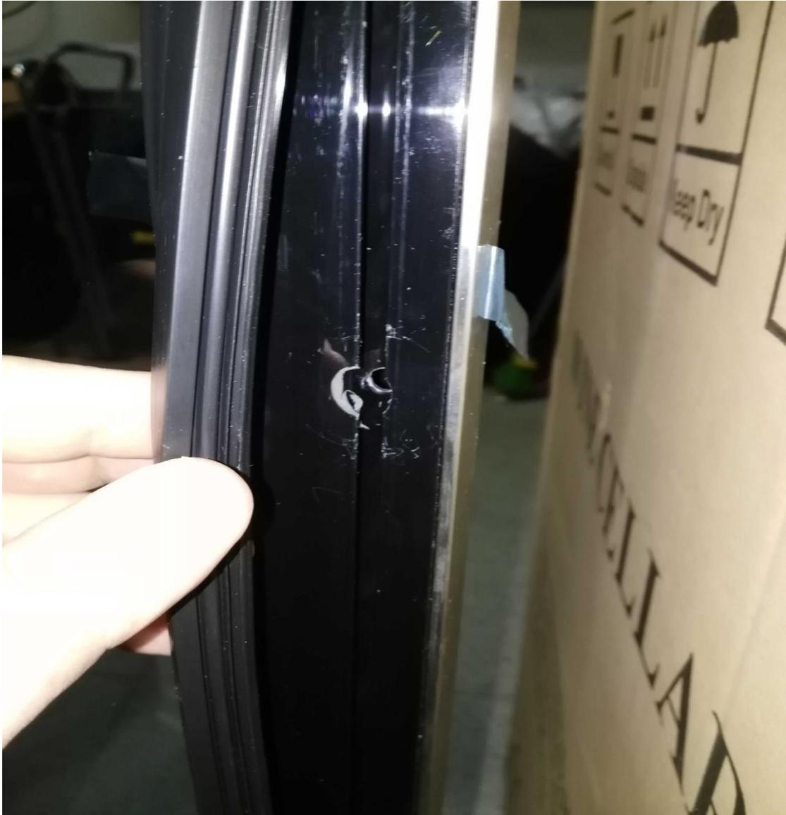
**2º Con la ayuda del tornillo, insertar la chapa dentro de la ranura y empujar hasta que el tornillo salga por el otro lado.**
